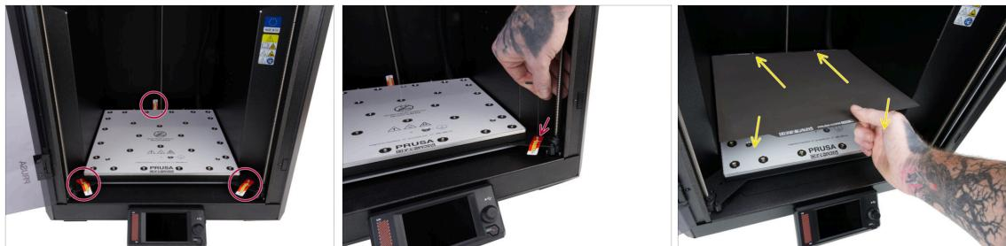
⚠ **¡Es imprescindible retirar los tornillos de la base calefactable antes de utilizar la impresora!**
