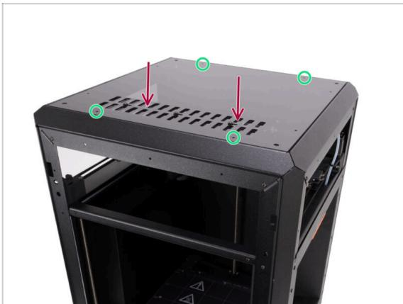
➊ Alignez le capot avec l'encoche sur l'imprimante, en veillant à ce que l'orifice de ventilation soit orienté vers l'avant.
