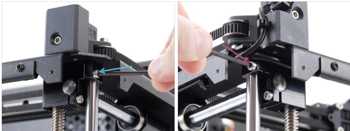
⚠ Vérifiez que les deux tiges lisses sont correctement placées dans les supports.
