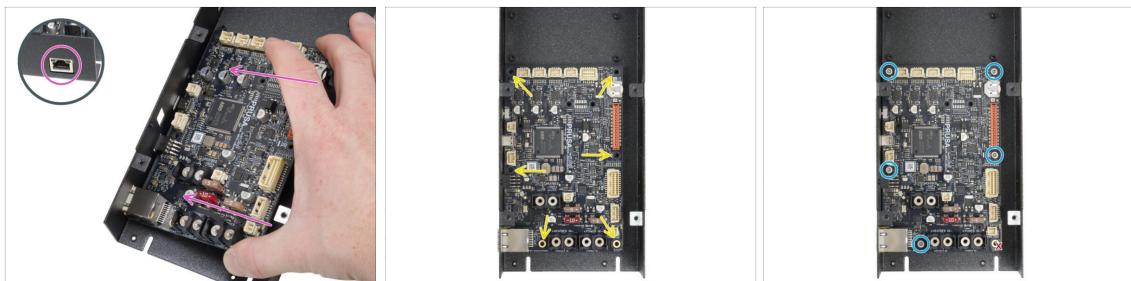
**⚠ Toca siempre los lados de la placa mientras la manipulas. Evita tocar los chips, condensadores y otras piezas de la electrónica.**
