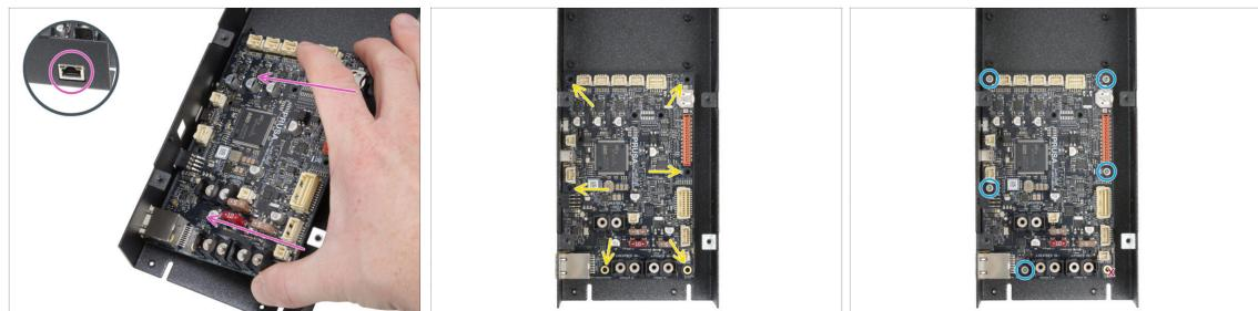
**⚠️ Quando maneggi la scheda elettronica, tocca sempre e solo i lati della stessa. Evita di toccare i chip, i condensatori e altre parti dell'elettronica.**
