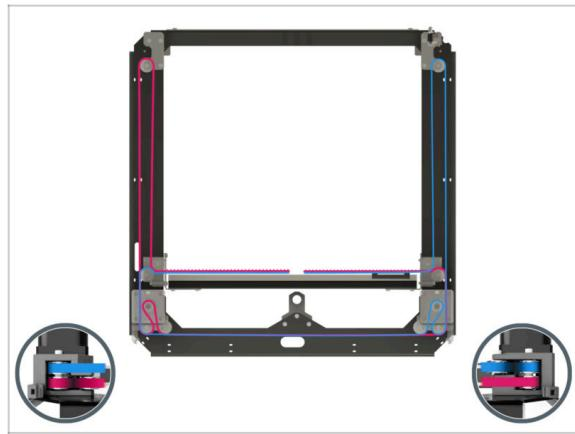
① I passi successivi descrivono l'installazione e la guida delle cinghie sul gruppo core XY. Prima di iniziare, guarda l'illustrazione per avere una visione d'insieme e capire meglio il percorso di ogni cinghia.
