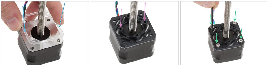
● Inserisci una guarnizione trasparente su ogni motore Z.
