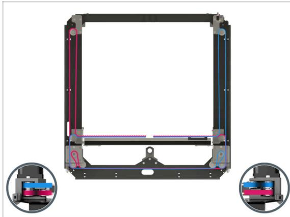
**i** I passi successivi descrivono l'installazione e la guida delle cinghie sul gruppo core XY. Prima di iniziare, guarda l'illustrazione per avere una visione d'insieme e capire meglio il percorso di ogni cinghia.
