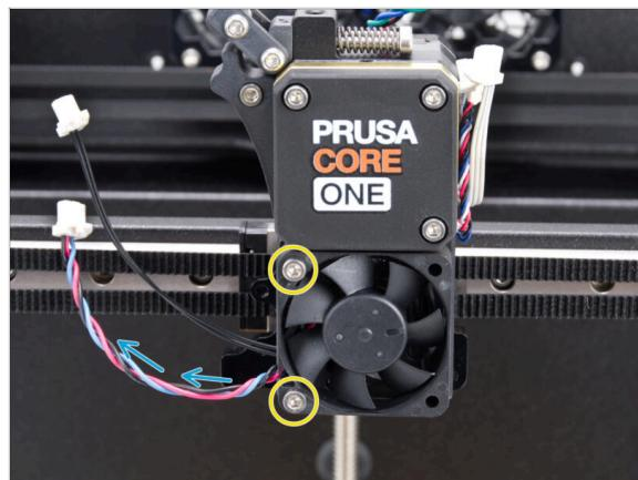
◆ Fixez le ventilateur de la hotend sur le dissipateur thermique avec deux vis M3x18 sur le côté gauche.
