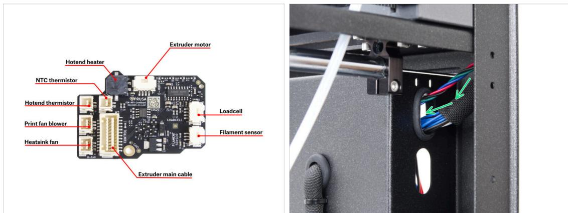
**⚠️ Bevor Sie die Elektronik abdecken, überprüfen Sie den Anschluss aller Kabel.**
