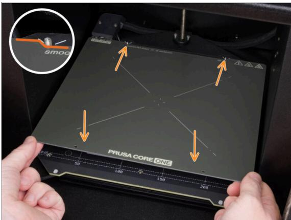
⚠ **Stellen Sie sicher, dass sich nichts auf dem Heizbett befindet.** Das Heizbett muss sauber sein. Jeder Schmutz kann die Oberfläche des Heizbetts und des Druckblechs beschädigen.
