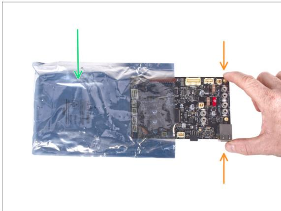
**⚠️ WARNUNG:** Stellen Sie sicher, dass Sie die **Elektronik vor elektrostatischer Entladung (ESD) schützen**. Packen Sie die Elektronik immer erst aus, wenn Sie sie brauchen!
