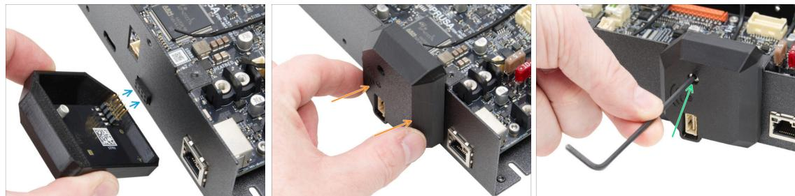
**⚠️** **Fai molta attenzione** quando maneggi e colleghi il modulo ESP in modo da **evitare di piegare e danneggiare i pin.**
