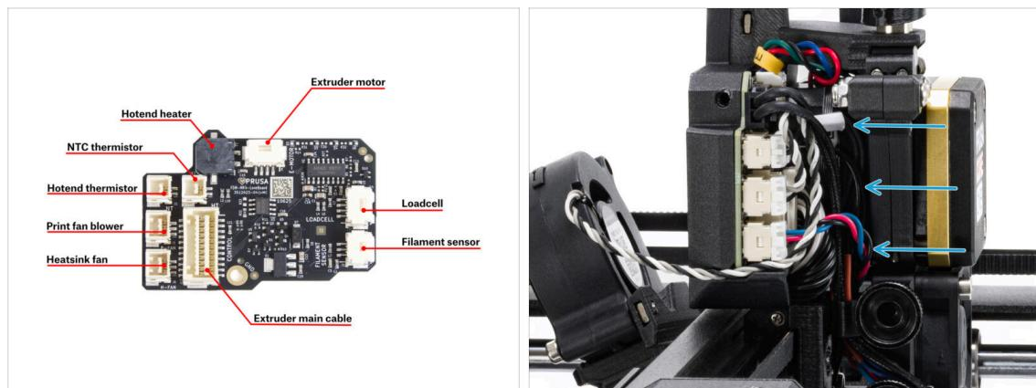
⚠ Prima di coprire l'elettronica, controlla il collegamento di tutti i cavi.
