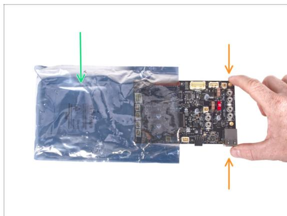
**⚠ ATTENZIONE: assicurati di proteggere i componenti elettronici dalle scariche elettrostatiche (ESD).** Se puoi, togli i componenti elettronici dalla confezione solo quando li devi usare.
