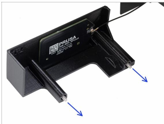
● Passez deux vis M3x10 à travers le EI-box-cover.
