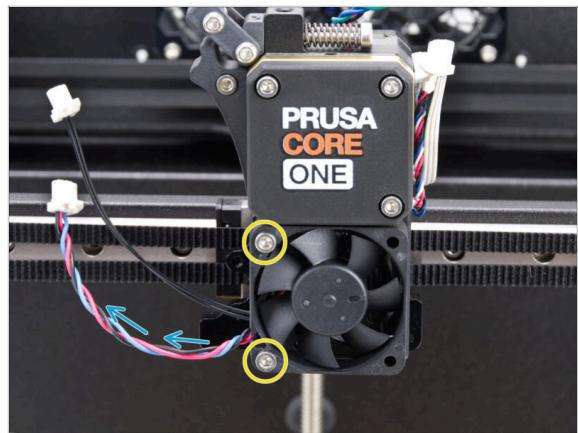
◆ Fija el ventilador del hotend al dissipador con dos tornillos M3x18 en el lado izquierdo. **Aprieta el tornillo suavemente, pero con firmeza, de lo contrario la carcasa de plástico podría agrietarse.**
