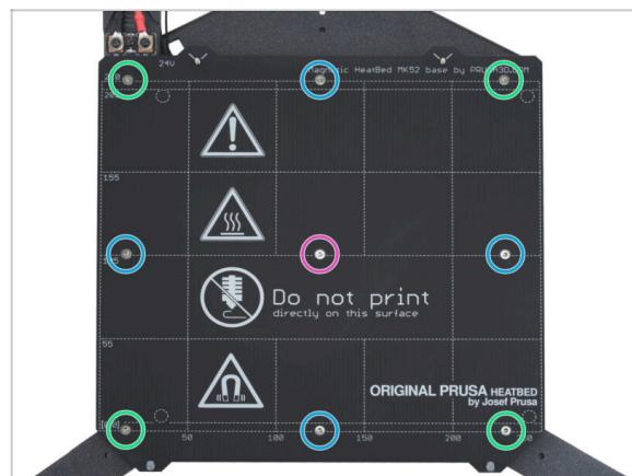
⚠ **IMPORTANTE:** La base calefactable debe apretarse en un orden específico. Repite la secuencia varias veces, asegurando el apriete final después de al menos dos rondas.
