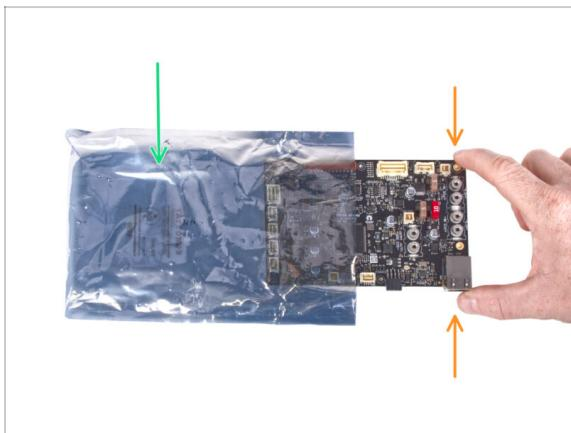
**⚠ ADVERTENCIA: Asegúrate de proteger la electrónica contra descargas electrostáticas (ESD). Cuando sea posible, desempaquetá siempre los componentes electrónicos justo antes de que los necesites.**
