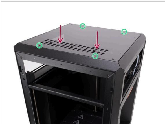
➊ Alinea la cubierta con el hueco de la impresora, asegurándote de que la rejilla de ventilación quede orientada hacia delante.
