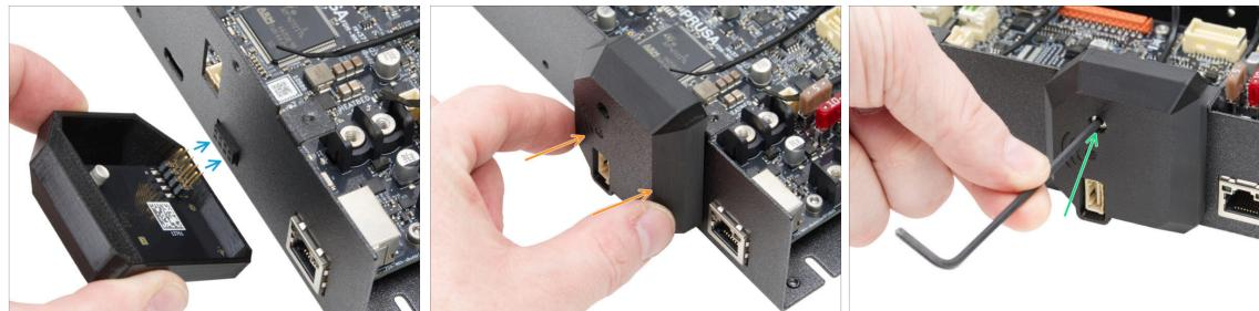
**⚠ Soyez très prudent lors de la manipulation et de la connexion du module ESP pour éviter de plier et d'endommager les broches.**
