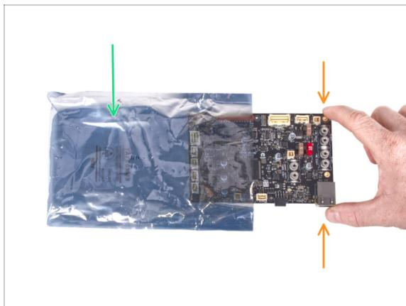
**⚠ ATTENTION : Assurez-vous de protéger l'électronique contre les décharges électrostatiques (ESD).** Dans la mesure du possible, déballez toujours l'électronique juste avant d'en avoir besoin.
