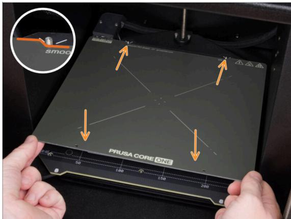
**!** **Asegúrate de que no haya nada sobre la base calefactable.** La base calefactable debe estar limpia. Cualquier suciedad puede dañar la superficie tanto de la base calefactable como de la lámina de impresión.
