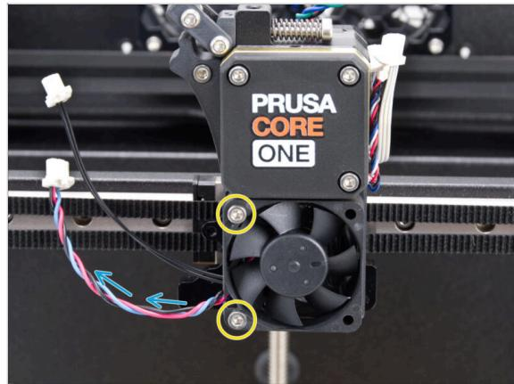
◆ Fija el ventilador del hotend al disipador con dos tornillos M3x18 en el lado izquierdo. **Aprieta el tornillo suavemente, pero con firmeza, de lo contrario la carcasa de plástico podría agrietarse.**
