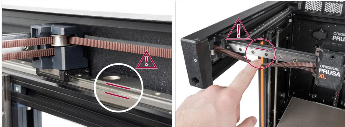
**⚠ ATTENZIONE:** evita il contatto diretto sulla pelle con il lubrificante utilizzato per le guide lineari di questa stampante. In caso di contatto, lavati immediatamente le mani. Soprattutto prima di mangiare, bere o toccarsi il viso.
