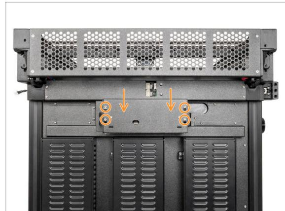
ⓘ Dans cette étape, couvrez temporairement l'électronique. Il s'agit de protéger l'électronique lors de l'installation des têtes d'outils dans le chapitre suivant. Le capot de l'électronique n'a pas besoin d'être serré.
