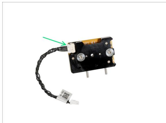
◆ Connectez le câble du changeur d'outils au changeur d'outils.
