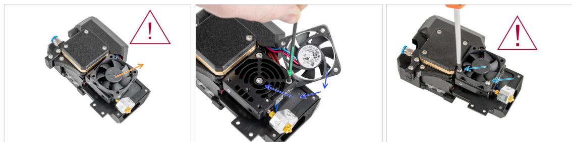
**⚠️ Le ventilateur du dissipateur thermique est toujours connecté, soyez doux avec les câbles !**
