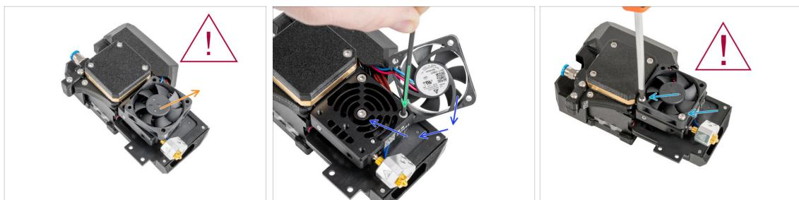
**⚠️ El ventilador del disipador está aún conectado, ¡ten cuidado con los cables!**
