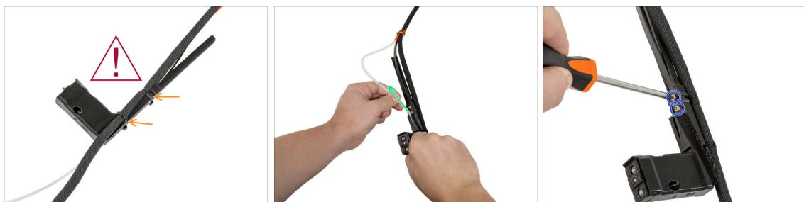
**⚠ Achten Sie beim Schneiden der Kabelbinder auf das schwarze Kabelbündel!**
