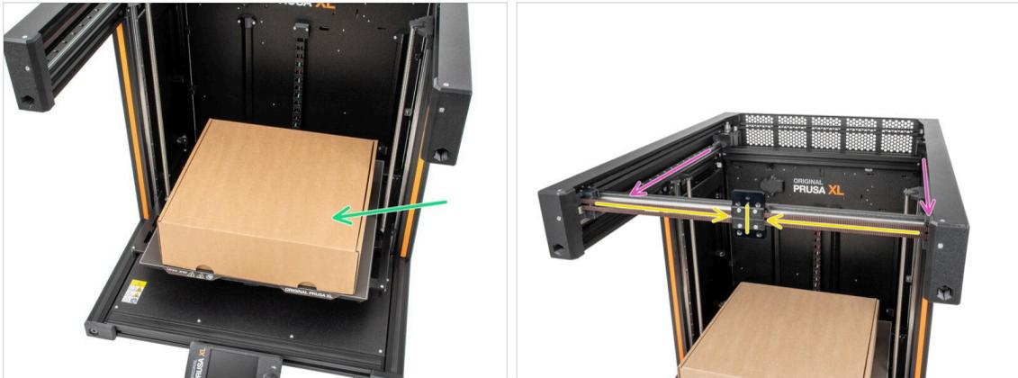
**⚠** Rappel : Pour manipuler l'imprimante, **saisissez toujours les poignées des deux côtés de l'imprimante**. Ne soulevez pas l'imprimante par les profilés aluminium ou les profilés en tôle situés sur le dessus.
