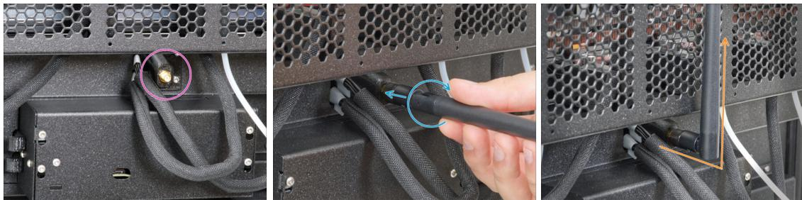
ⓘ Cette étape concerne uniquement l'imprimante, qui dispose d'une antenne Wi-Fi à l'arrière de l'imprimante. Si vous avez l'**antenne sur le côté** de l'imprimante, **passez à l'étape suivante**.
