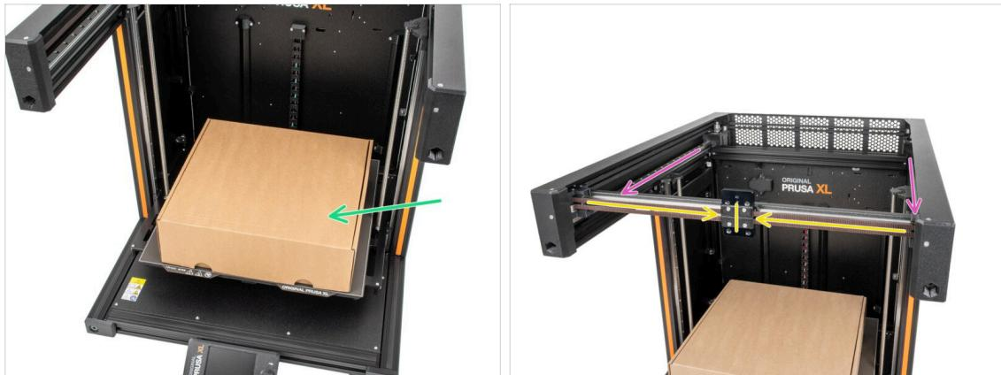
**⚠ Recordatorio:** Para manipular la impresora, **agarra siempre las asas situadas a ambos lados de la impresora**. No levantes la impresora sujetándola por las extrusiones de aluminio o por los perfiles de chapa metálica superiores.
