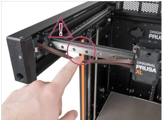
⚠ **ACHTUNG: Vermeiden Sie direkten Hautkontakt mit dem Schmiermittel, das für die Linearführungen in diesem Drucker verwendet wird. Wenn es zu einem Kontakt kommt, waschen Sie sich sofort die Hände. Insbesondere vor dem Essen, Trinken oder Berühren des Gesichts.**
