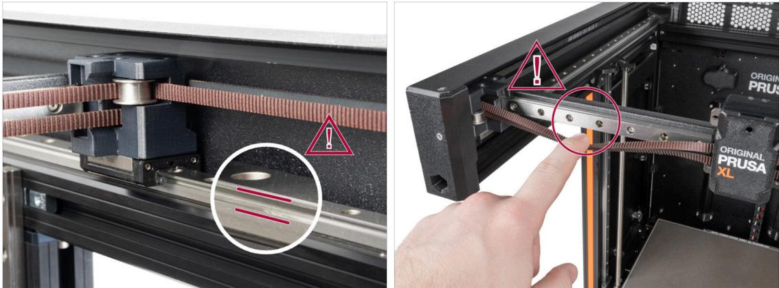
**⚠ ACHTUNG: Vermeiden Sie direkten Hautkontakt mit dem Schmiermittel, das für die Linearführungen in diesem Drucker verwendet wird. Wenn es zu einem Kontakt kommt, waschen Sie sich sofort die Hände. Insbesondere vor dem Essen, Trinken oder Berühren des Gesichts.**
