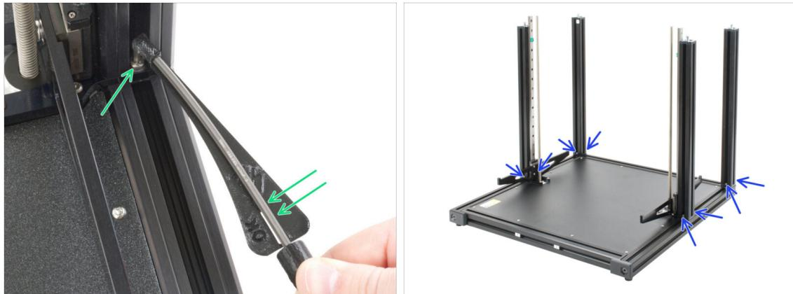
**⚠️ Attention : assurez-vous que la clé Allen est insérée COMPLÈTEMENT dans la vis. Ne serrez pas trop les vis au-dessus de l'échelle de l'indicateur de couple !**
