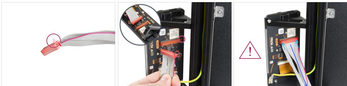
**⚠** Le connecteur du câble xLCD est doté d'un loquet de verrouillage qui doit faire face au triangle rouge près du connecteur xLCD.
