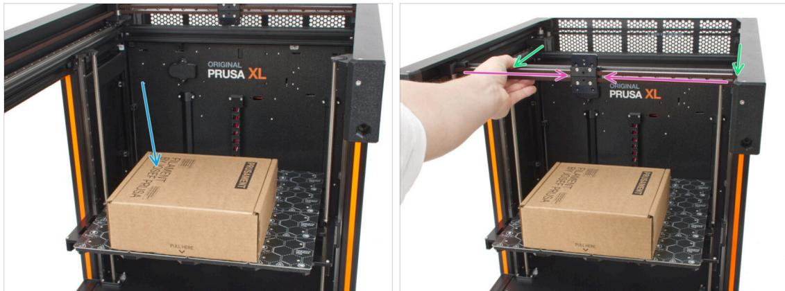
**⚠** Pour manipuler l'imprimante, **saisissez toujours les poignées des deux côtés de l'imprimante**. Ne soulevez pas l'imprimante par les profilés en aluminium ou les profilés en tôle situés sur le dessus.
