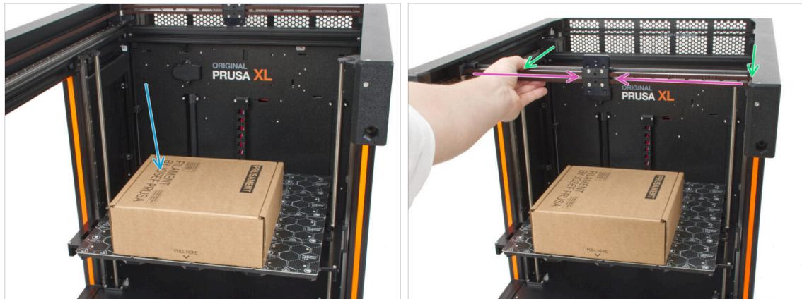
**⚠️ Para manipular la impresora, agarra siempre las asas situadas a ambos lados de la impresora. No levantes la impresora sujetándola por las extrusiones de aluminio o por los perfiles de chapa metálica superiores.**
