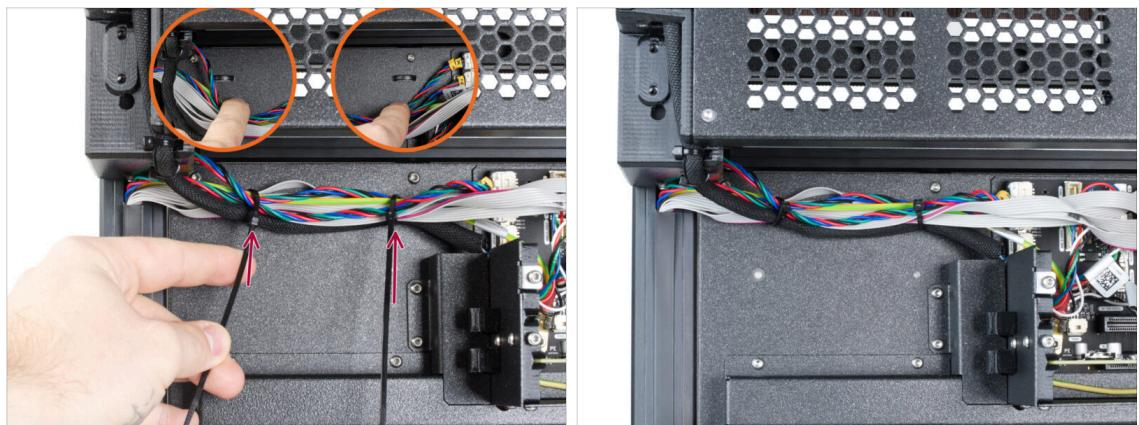
**⚠ Achtung:** Ziehen Sie die Kabelbinder nicht zu fest an! Sonst riskieren Sie eine Beschädigung der Kabel.
