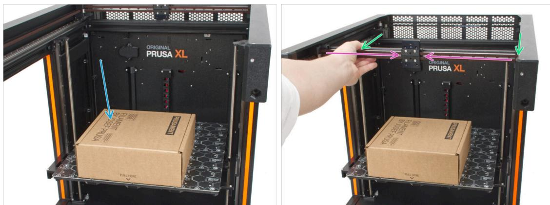
**⚠** Um den Drucker zu bewegen, **fassen Sie den Drucker immer an den Griffen auf beiden Seiten an**. Heben Sie den Drucker nicht an den Aluminiumprofilen oder den oberen Blechprofilen an.
