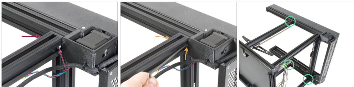
➤ Setzen Sie die M4x12 Schrauben in beide Löcher ein. Auf die gleiche Weise wie beim Grundrahmen.
