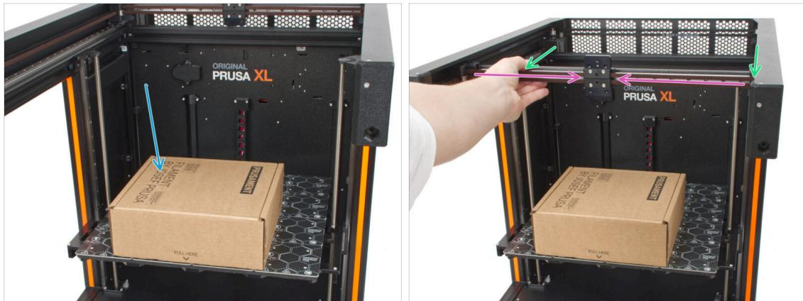
**⚠️** Chcete-li s tiskárnou manipulovat, **vždy uchopte rukojeti po obou stranách tiskárny**. Nezvedejte tiskárnu za hliníkové extruze nebo profily z kovových plechů nahoře.
