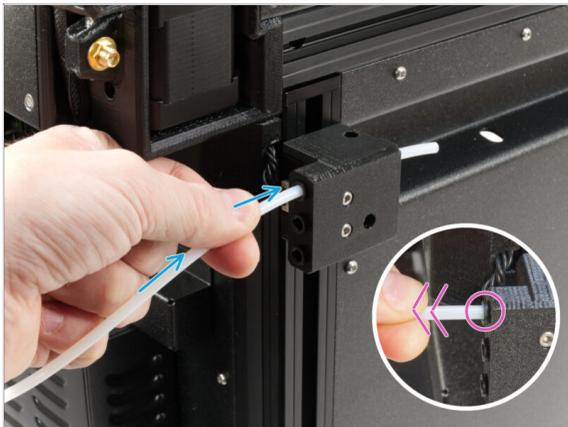
◆ Localiza el sensor de filamento lateral en el lateral de la impresora. Inserta el tubo PTFE del extrusor libre lo más lejos posible en el orificio superior del sensor de filamento.
