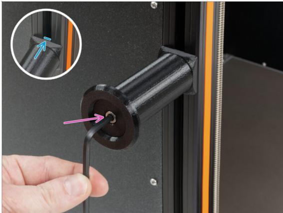
● Fija el conjunto del portabobinas a la tuerca M5nEs de la extrusión. Ten en cuenta que hay un saliente en el montaje del portabobinas, que debe encajar en la ranura de la extrusión.
