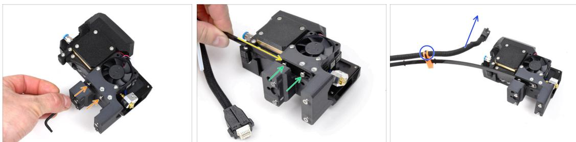
● Lösen Sie mit dem T10-Schlüssel die beiden markierten Schrauben an der Innenseite des Nextruders.
