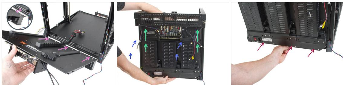
**⚠ Durante il montaggio, tieni il pannello posteriore XL con la mano! Non è fissato con viti.**
