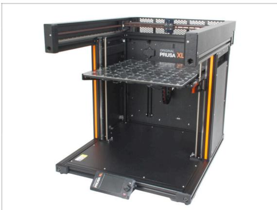
◆ Ben fatto! Hai appena terminato l'assemblaggio del piano riscaldato e del pannello laterale.
