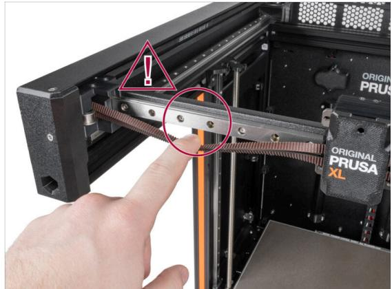
**⚠ ATTENZIONE: evita il contatto diretto sulla pelle con il lubrificante utilizzato per le guide lineari di questa stampante. In caso di contatto, lavati immediatamente le mani. Soprattutto prima di mangiare, bere o toccarsi il viso.**
