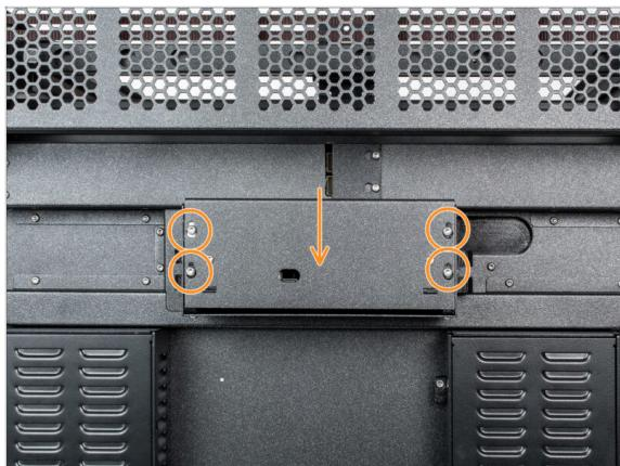
**i** In questa fase, copri temporaneamente l'elettronica. Questo serve a proteggere l'elettronica durante l'installazione delle teste degli strumenti nel capitolo successivo. Non è necessario stringere il coperchio dell'elettronica.
