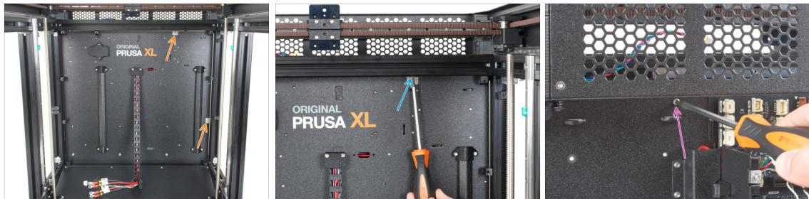
**⚠ Durante il montaggio, tieni il pannello posteriore della XL con la mano, in modo da poterlo fissare con le viti.**
