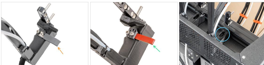
**i** I gruppi più recenti vengono forniti con la guarnizione dell'ugello preinstallata sul dock dell'estrusore.
