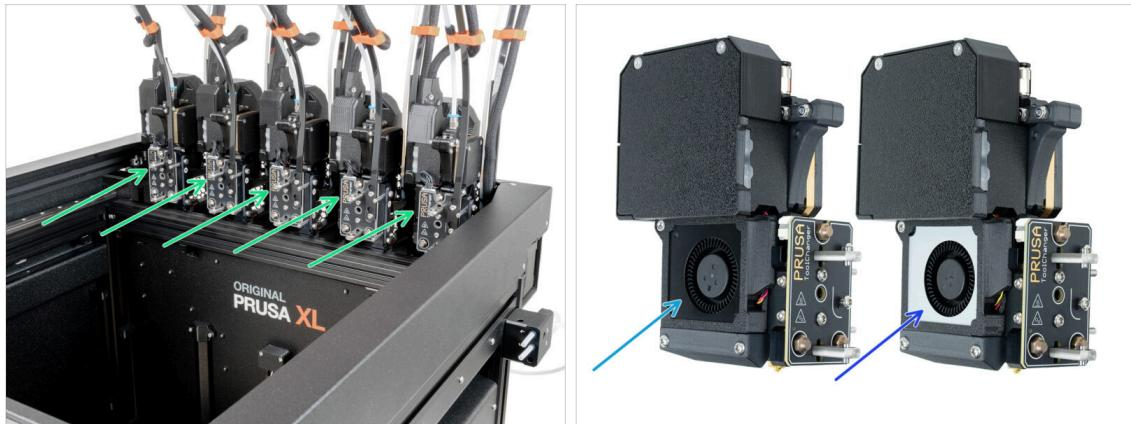
⚠ A partir de enero de 2026, los cabezales de impresión se envían con un ventilador de impresión plateado. Comprueba el color del ventilador de impresión instalado en el cabezal de impresión. En el siguiente paso, confirmarás el tipo de ventilador de impresión en el menú de la impresora.
