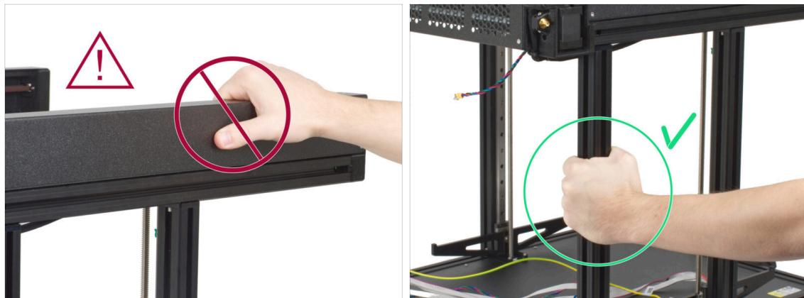
**⚠ Nunca manipules la impresora utilizando los lados metálicos superiores. Puedes dañar las luces LED ocultas en el interior.**
