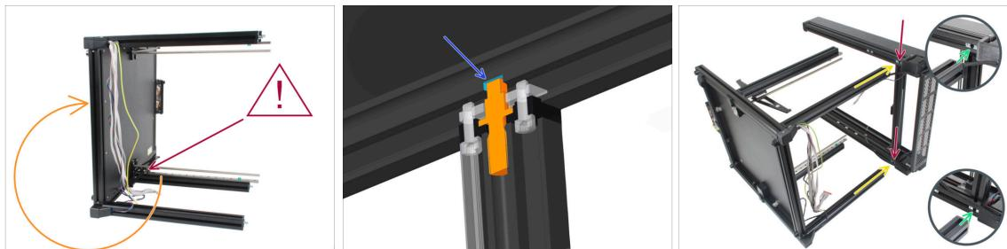
⚠ Comprueba que los conjuntos fijo y giratorio del eje Z están en las posiciones correctas. En la imagen, el eje Z fijo está en la parte inferior, lo cual es correcto. Comprueba tu impresora.
