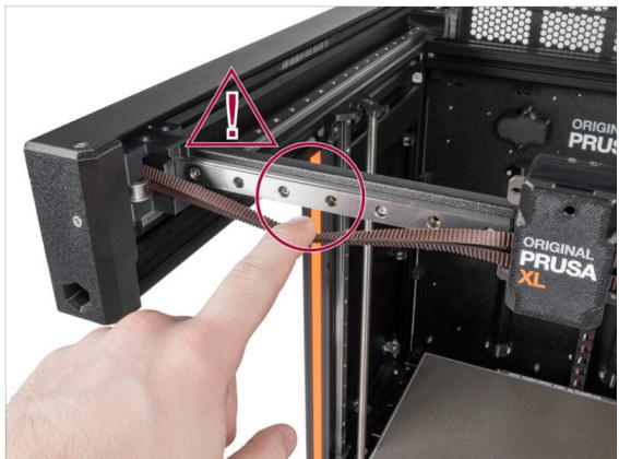
**⚠ PRECAUCIÓN: Evita el contacto directo de la piel con el lubricante utilizado para las guías lineales de esta impresora. Si se produce un contacto, lávate las manos inmediatamente. Especialmente antes de comer, beber o tocarte la cara.**
