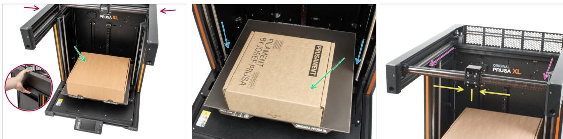
⚠ **Recordatorio:** Para manipular la impresora, **agarra siempre las asas situadas a ambos lados de la impresora**. No levantes la impresora sujetándola por las extrusiones de aluminio o por los perfiles de chapa metálica superiores.
