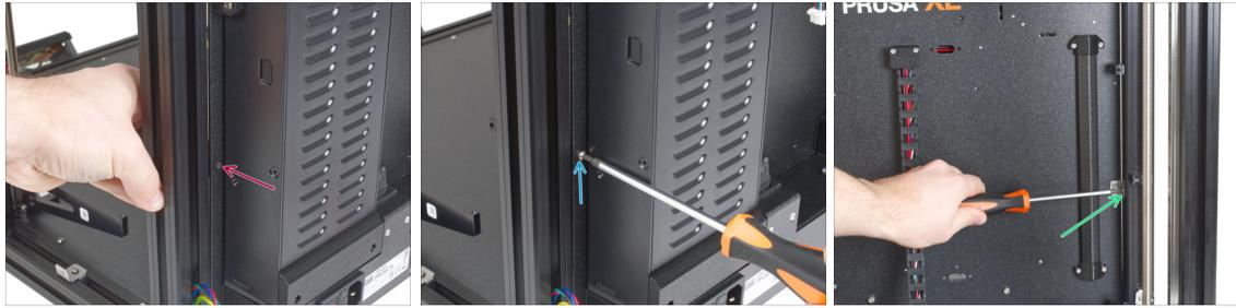
**⚠ ¡Sujeta el panel trasero XL con la mano durante el montaje! Hasta que se fije con tornillos.**
