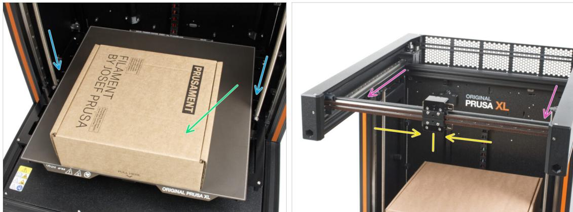
**⚠** Zur Erinnerung: Um den Drucker zu bewegen, **fassen Sie den Drucker immer an den Griffen auf beiden Seiten an**. Heben Sie den Drucker nicht an den Aluminiumprofilen oder den oberen Blechprofilen an.
