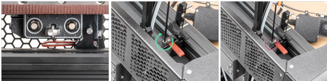
**⚠ Questa regolazione è importante!** Assicurati che l'altezza della guarnizione dell'ugello sia impostata correttamente, altrimenti potrebbe gocciolare del filamento fuso dal nextruder.
