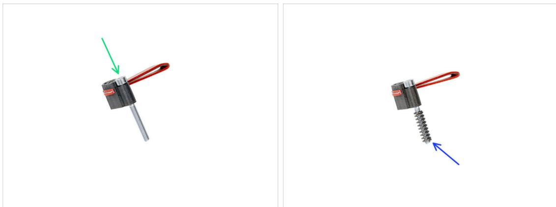
● Inserisci la vite M3x30 in ogni guarnizione dell'ugello.
