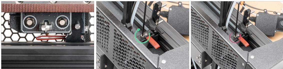
**⚠ Ce réglage est important ! Assurez-vous que la hauteur de l'Obturateur de Buse est correctement réglée, sinon le Nextruder pourrait laisser couler du filament fondu.**
