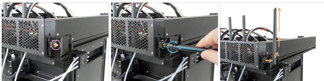
◆ Localisez le connecteur d'antenne Wi-Fi dans le coin arrière droit de l'imprimante.
