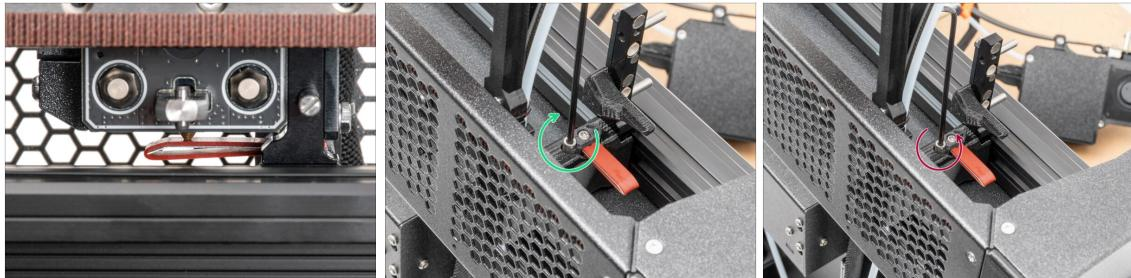
**⚠ ¡Este ajuste es importante!** Asegúrate de que la altura del Sello de boquilla está ajustada correctamente, o el(los) nextruder(s) podría gotear filamento fundido.
