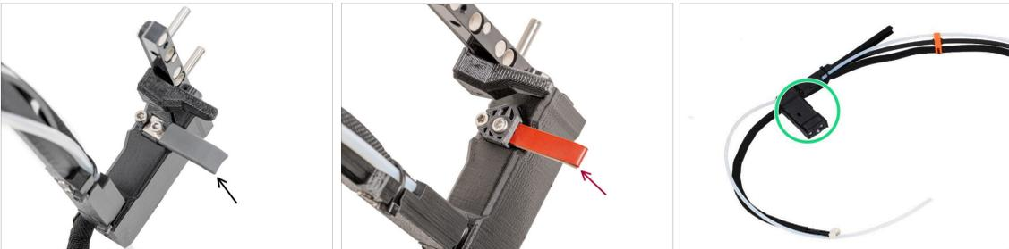
**i** Los últimos conjuntos vienen con la junta de la boquilla preinstalada en el dock del extrusor.
