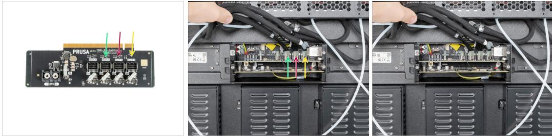
**⚠ No saques la placa XL-Splitter de la impresora aún, la foto es sólo una ilustración de la ubicación de los conectores.**
