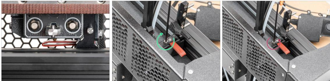
**⚠ Diese Einstellung ist wichtig!** Stellen Sie sicher, dass die Höhe der Düsendichtung richtig eingestellt ist, da sonst geschmolzenes Filament aus dem Extruder tropfen könnte.
