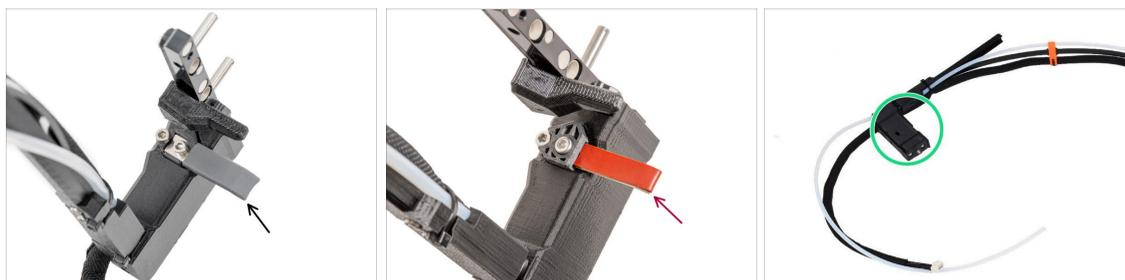
**i** Bei den neuesten Baugruppen ist die Düsendichtung bereits auf dem Extruderdock installiert.
